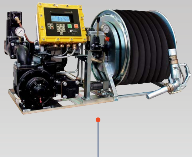
Sistema de medida para camiones de reparto con calculador electrónico ME3000, bomba, válvulas neumáticas VN, accionamiento hidráulico de bomba y devanadera, enfriador de aceite, devanadera axial y/o radial, sonda de temperatura, manguera y boquerel.
