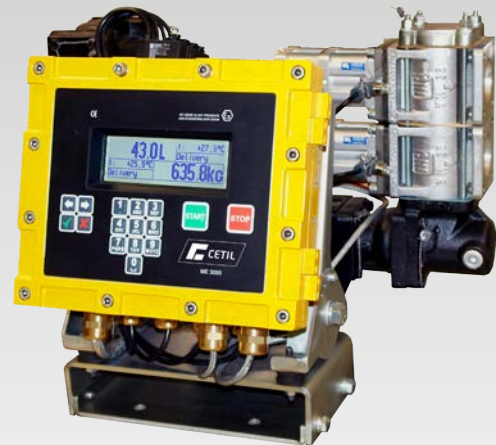
Contador con calculador electrónico ME3000 con doble indicación para controlar dos cámaras simultáneamente. Cada cámara puede tener múltiples válvulas neumáticas VN para salida por varias puntos no simultáneos, sonda de temperatura (opcional), y predeterminación de la cantidad a suministrar.
